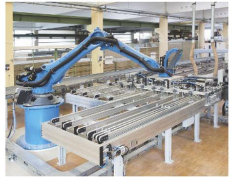
*/ Fleißiger Blaumann: Der Roboter übergibt an die Rückführung und stapelt die fertigen Teile ab.*
