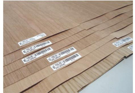
*/ ... kopfseitig so aufgeklebt, dass es beim Zuschnitt auf der Plattensäge zum Programmstart dient.*
