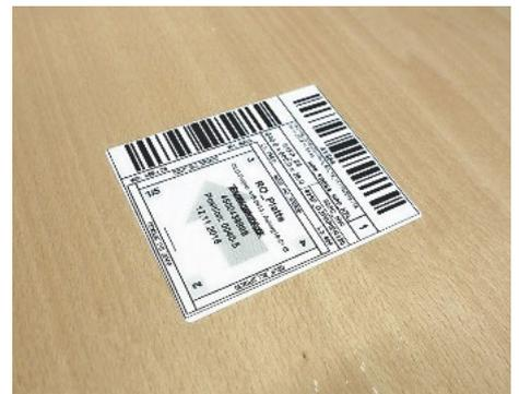
*/ Die Etiketten tragen alle Infos für die Weiterbearbeitung auf der Kantenanleim- und den CNC-Maschinen.*
