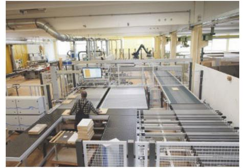
*/ Blick auf die neue Kantenbearbeitung. Bedient wird sie von lediglich einem Mitarbeiter.*
