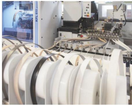
*/ Die Homag hat sowohl ein LaserTec- als auch ein Schmelzklebeaggregat an Bord.*
