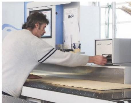
*/ Nach erfolgtem Zuschnitt werden die furnierten Teile dann mit einem Standard-Etikett versehen.*
